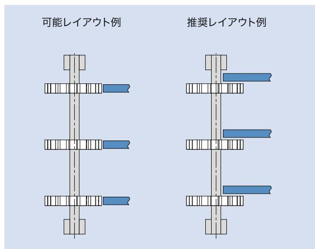
平行ウェアストリップをご使用の場合、スプロケットが支えられない部分を支持するようスプロケットの間に配置し、隙間を最低限に抑えることをお勧めします。
