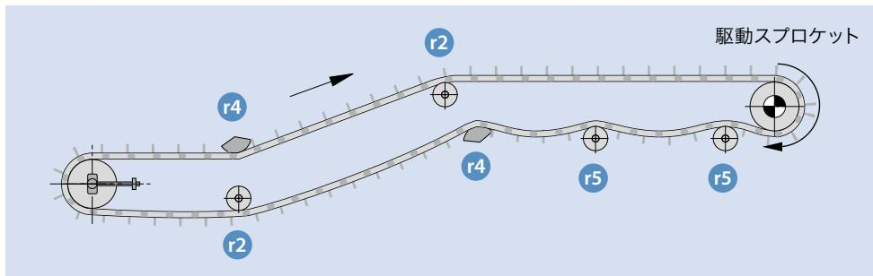
Z形コンベヤ（スワンネック）でベルト幅が600 - 800mm (24 - 32インチ) 以上のものには追加のガイド/固定システムが必要です。ベルトが直進から傾斜に角度を変えるとき、600mm (24インチ) 以上の比較的幅の広いベルトにおいてはベルトの両サイドの抑えだけでは不十分です。そのような場合には、ベルトの逆曲げをガイドするためにベルトの下面にホールドダウンタブをつけます。各シリーズの推奨最小逆曲げ半径 (r4) に関しては、データシートをご参照ください。
