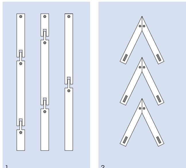
支持部を設置するとき、必ず温度による膨張と縮小をご考慮ください。ウェアストリップの適切な間隔（[第4.4章「温度の影響」をご覧ください](#)）によりその影響を排除することができます。実際の作動温度範囲において、問題なく走行
