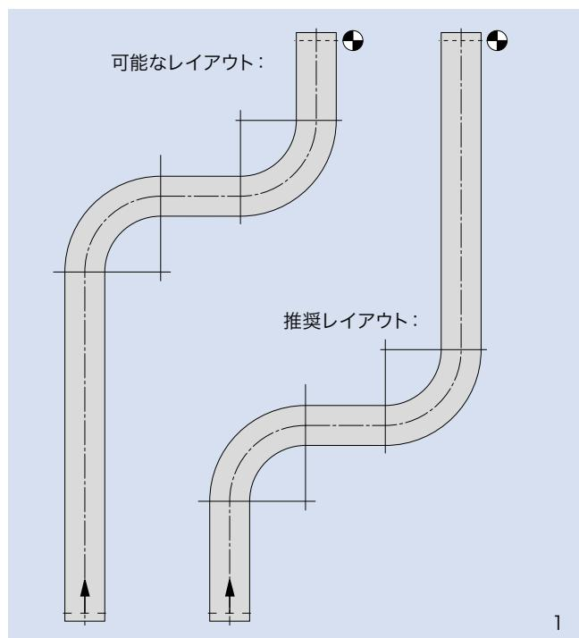
カーブ手前の直線部は、ベルト幅以上の長さに設定ください。連続するカーブ間およびカーブ後の直線部長さは、ベルト幅の2倍以上に設定してください。連続するカーブが同じ方向に曲がる場合は、カーブ間距離を減らすことができます。(2)
