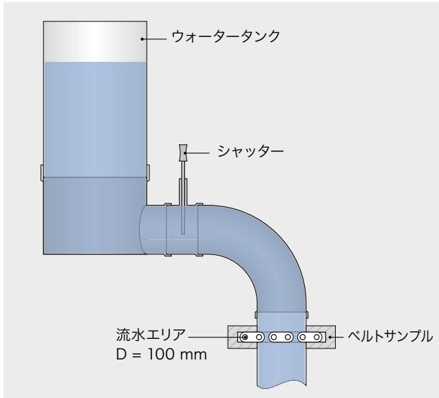
このため、当社はモジュラーベルトの排水試験を発案しました。公表されている「流量(FLOW RATE)」は1秒あたりのリットル数(l / s)で定義されており、排水用途に適したベルトを選択をサポートします。
