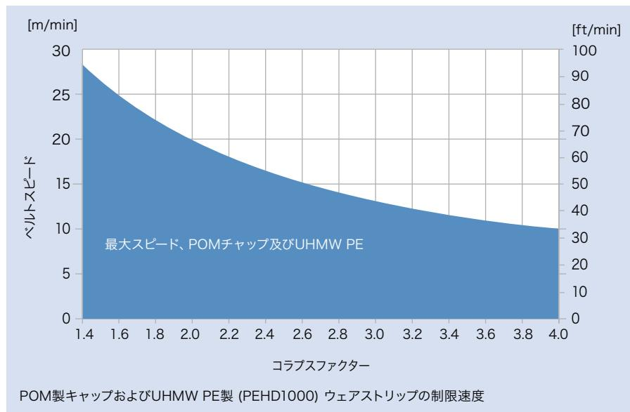
高速で使用されるカーブベルトに関し、S11は通常のPOM材質のキャップに替えて、特別に強固なキャップ材質を提供します。この材質コードは「HW」と表されます。この際、ウェアストリップの材質として「ナイラトロンNSM」が推奨されます。これは潤滑剤が添加された特別なPA(ポリアミド)材質です。ほとんどの場合、シリーズ11のHWキャップとナイラトロンNSMの組合せにすることで、高い負荷がかかる摩耗しやすい用途において、ベルト寿命をより長くすることができます。
