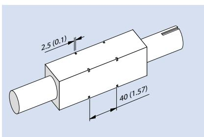
シャフト40 X 40mm。スプロケットをリングで固定します。参照:DIN 471 (Seeger circlip ring) d = 56mm。詳細寸法はpage VI-11を参照ください
