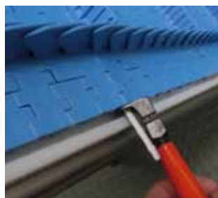
4 ベルトエッジの後ろから突き出すロッドの端を切ってください。
