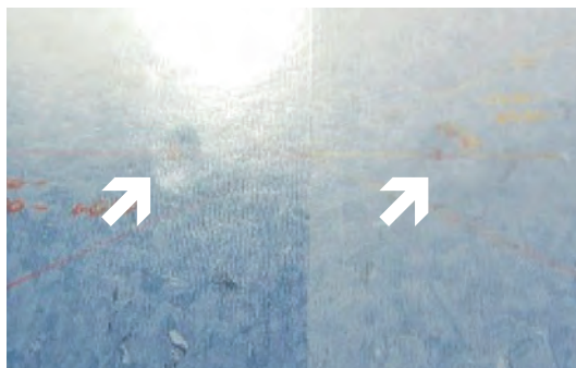
Abb. 5: Sichtbarkeit der Eindrücke nach Belastung in Abhängigkeit vom Glanzgrad [1]
