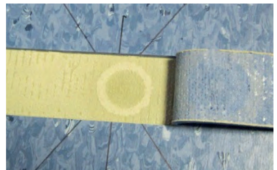
Abb. 6: Klebstoffverquetschung nach Belastung [1]
