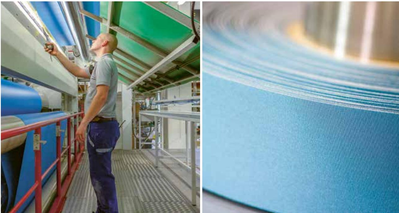
BioBelt sind erdölbasierte Rohstoffe und synthetisch-technische Kunststoffe weitgehend durch Materialien aus nachwachsenden pflanzlichen Rohstoffen ersetzt worden. Noch ist die Nachfrage nach einem solchen Transportband eher gering.
