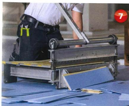
Aufgrund der modularen Form sind genaue Kantenschnitte mittels Stanze leicht zu bewerkstelligen.
