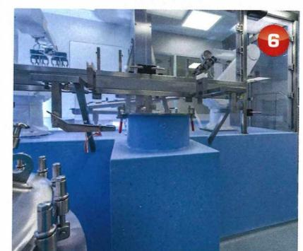
Aufgrund der speziellen Zusammensetzung lässt sich Colorex schleifen, thermisch verformen oder aber homogen verschweißen. Das gilt auch für Säulen, Kanten und Stufen.
