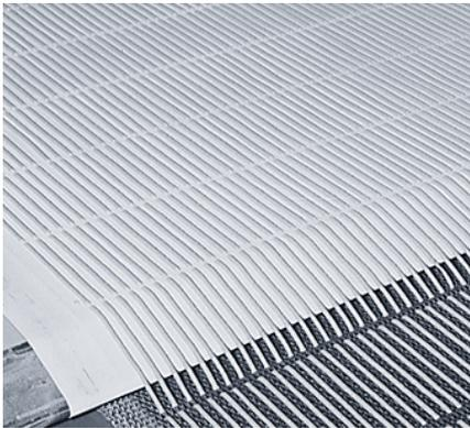
Belt tepi pisau Siegling Transilon fleksibel secara longitudinal pada khususnya dan rigid secara lateral. Sangat cocok untuk digunakan pada ujung pisau pada radius 3 mm.
