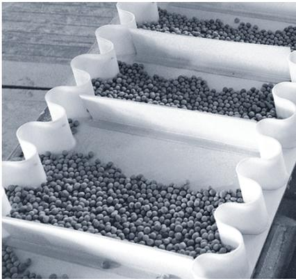
Belt conveyor yang dilengkapi dengan profil digunakan untuk menghantarkan produk berukuran besar dan benda-benda kecil.
