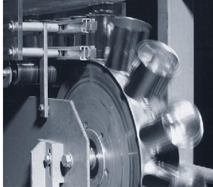
Belt NA Siegling Transilon diproduksi tanpa elemen antistatik yang konduktif listrik. Diuji sesuai ISO 21178, ketahanan permukaan elektrik  $R_{Di}$  lebih besar dari  $3 \times 10^8 \Omega$ .
