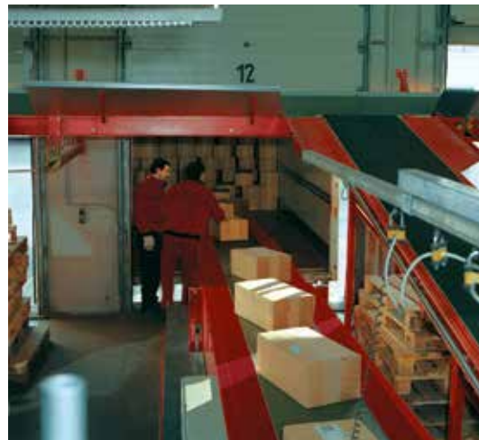
伸缩输送机皮带 — 这里用于卡车卸货 — 必须设计成能在反向弯曲下运行, 同时还要承受高冲击负载。
