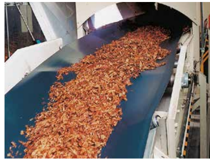
使用成槽皮带的水平输送。强力层结构提供了皮带在特定方向的灵活性。
