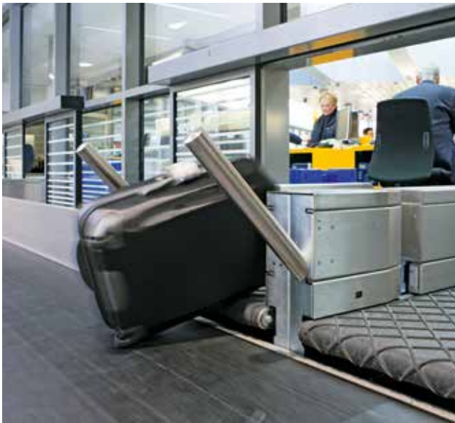
机场值机区域的收集带 — 这里, 皮带的平整性确保了物品在皮带 (甚至是宽皮带) 侧面的顺利卸载, 对于现代机场, 阻燃是皮带的“必须”要求。
