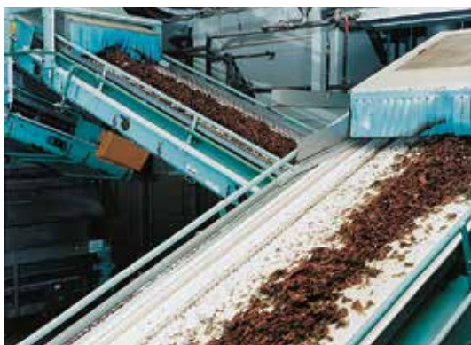
爬坡输送在烟草行业中的应用。在这类应用中，光滑表面的皮带可能达到的输送角为 22^{\circ} 。
