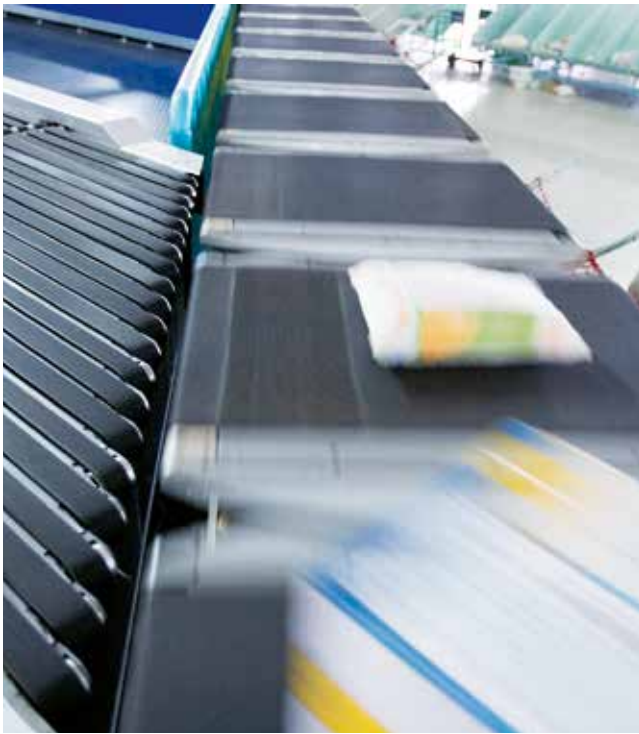
物流中心的横向分拣机。高加速度要求皮带表面具有极高的摩擦系数。
