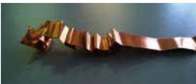
Afin d'obtenir un bon contact entre le ruban de cuivre et le dos de la dalle Colorex Plus, nous recommandons de replier le ruban de cuivre. (voir illustration)
