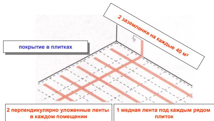
После высыхания **токопроводящей дисперсионной грунтовки 041 Europrimer EC** (прибл. через 30 минут) или после выполнения сетки из **медной ленты 801**, подготовить и уложить напольное покрытие, используя токопроводящий клей **523 EUROSTAR TACK EC**. Данный клей характеризуется высокой начальной и конечной kleящей силой. После вскрытия банки клей следует тщательно перемешать и наносить на основание с помощью зубчатого шпателя.
