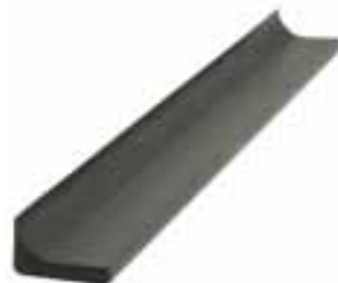
Plintprofiel , kan los worden gelegd tussen tegels en wand. 2500 mm lang x 50 mm breed, rubber.
