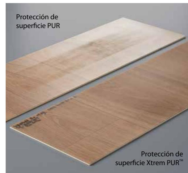
Resistencia extrema a las rayadas tras realizar pruebas de pulido abrasivas (300 ciclos) en comparación con el tratamiento de superficie PUR estándar
