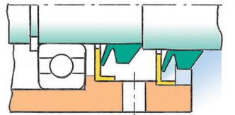
V-リングシールを2個取り付け、中間にドレン孔を設けると、より過酷な条件でも使用できます。
