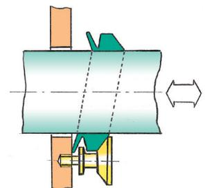
軸が熱膨張で軸方向に動く場合は、オートアジャスターを使用してください(軸が回転している時、V-リングシールはカウンターフェイスに対して自動的に正しい位置になります)。
