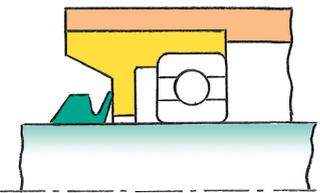
V-リングシールを機械的な損傷から保護する必要がある場合には、上図の方法で取り付けると効果的です。
