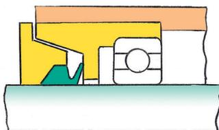
V-リングシールをラビリンスシールとして使用することもできます。上図の方法を用いると、ベアリング・ハウジングは密閉状態になり、温度変化や静止条件に起因する汚染物質の通り抜けが防止されます。
