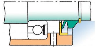
V-リングシールの一部ないし全体が水中に没した状態で水をシールする場合のシール系は、[V-リングシール] + [ドレン孔]で構成してください。
