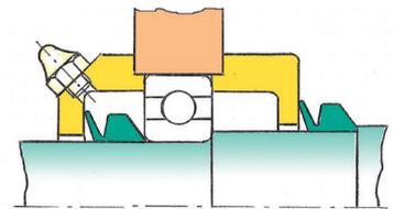
油潤滑時や周速が7m/s以上、またはV-リングシールをグリスバルブとして使用する場合、軸を段付き加工したストッパーを使用されることをお勧めします。
