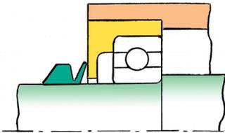
ベアリングの潤滑用グリスをシールする場合は、ハウジングの外側にV-リングシールを取り付けてください。この方法により、ダストや飛沫水の浸入が阻止され、同時に内部のグリスが保持されます。
