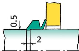
Sタイプを使用する場合は、軸に溝加工を施せばストッパーとなります。
