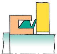
周速12m/s以下では、V-リングシールは固有の弾性で軸の所定位置に固定されます。それ以上の高速回転時には、食込み付き台座にV-リングシールを取り付けるか、スリーブまたはクランプバンドを併用して、V-リングシールを所定位置に固定してください。
