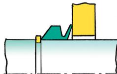
V-リングシールをオイルシールとして使用する場合は、軸方向のストッパーを必ず付けてください。
