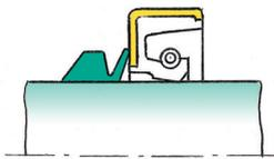
軸表面とオイルシールのリップを、ダストや磨耗性スリラーから保護するためには、V-リングシールを補助シールとしてお使いください。
