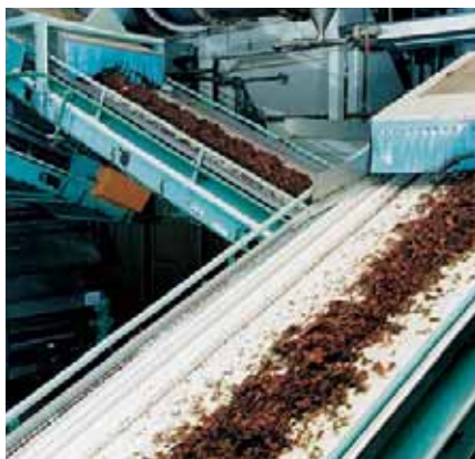
タバコ工場で使用される傾斜コンベアでは、 14^{\circ} ～ 15^{\circ} までの傾斜搬送が行える表面が平滑タイプのベルトが採用されています。
