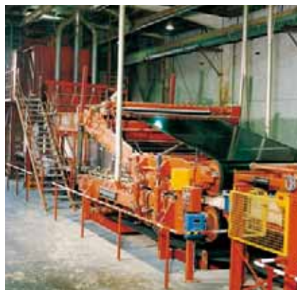
パーティクルボード製造で使用するプリプレスベルト、パーティクルマットは搬送過程で予備圧縮が行われます。
