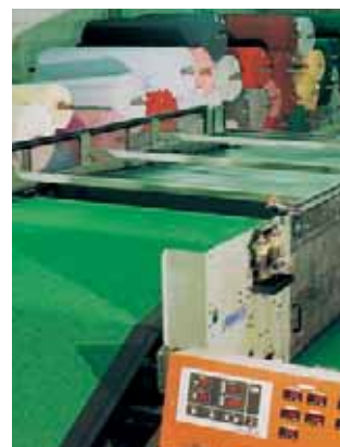
不織布産業で用いられるクロスラッパ一用ウェブレイニング・ベルト。高速で大量にウェブを生産する加工工程用ベルトには、非常に厳密な品質が要求されています。
