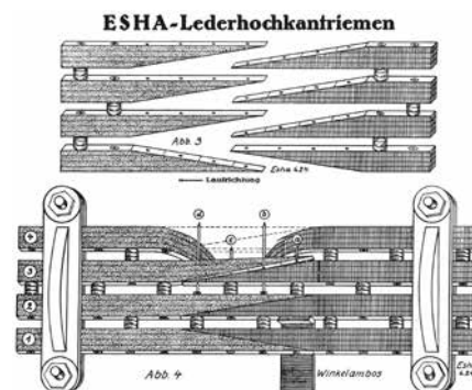
上: クローム革縦型ベルトの構造(1925年のスケッチから)
