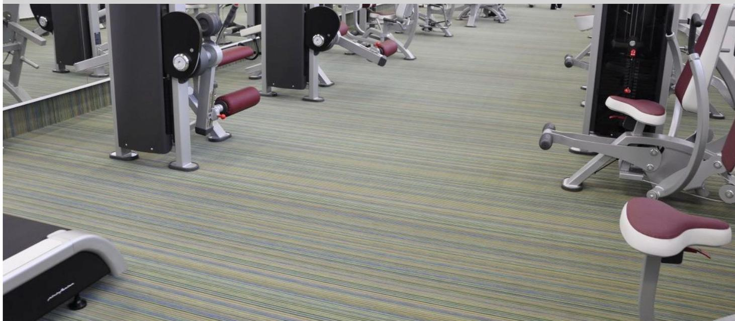
Le Flotex remplit le critère principal pour les caractéristiques acoustiques. Flotex absorbe parfaitement le bruit de la salle. Pour aider à réduire le bruit de manière plus efficace, Flotex a été installé sur les murs également.
