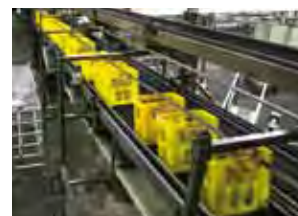
飲料搬送： 水分が介在する製品搬送にも適したタイプ
