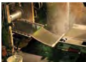
タイヤ工場： ゴムシート搬送ラインで使用される耐熱性に優れたタイプ
