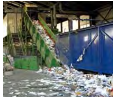
リサイクル業界： あらゆる搬送物にも耐えうる耐薬品性に優れたタイプ
